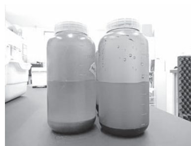
燃焼灰の種類（左）と溶出試験の様子（右）
